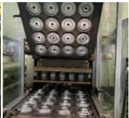
슬라이드 판 위에 금형이 설치된 모습
